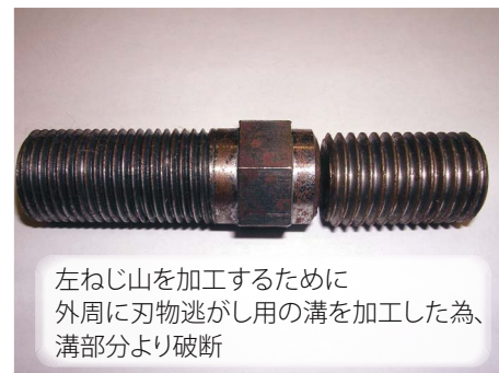
応力集中と繰り返し荷重により破損した部品
