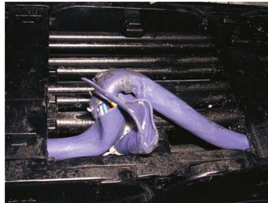
仕切り間隔が狭く、ケーブルの応力分散・吸収作用がうまく働かず外層皮膜が破断してケーブルがよじれてしまったケース
