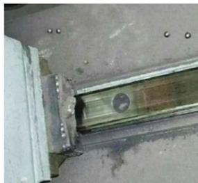
← リターンキャップが破損しボールが飛び出した状態
